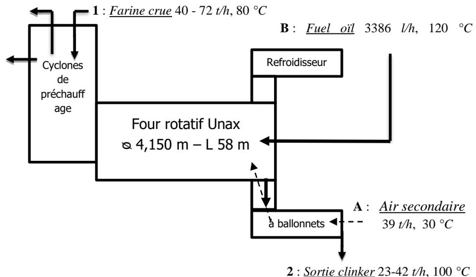
Figure 1: Le système du four rotatif Unax à refroidisseurs ballonnets
