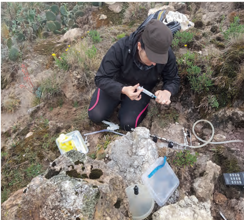
Mesure de la température et prélèvement de gaz en surface.
